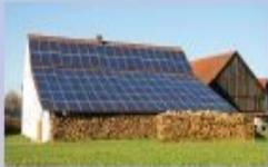
Cette centrale est issue d'une association culturelle et de travailleurs. Elle a été créée conjointement à la construction d'un hangar agricole. L'installation compte 198 panneaux photovoltaïques soit 330 m<sup>2</sup>, pour une puissance de 63 kWc soit environ 75000 kWh produits à l'année.
